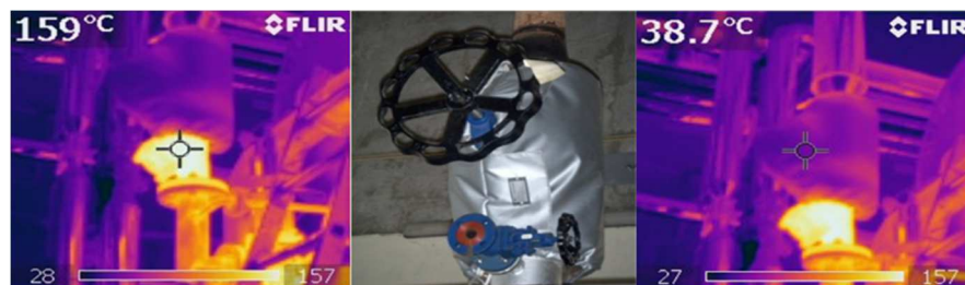
Figura 33 Comportamento do isolamento à temperatura [33].
